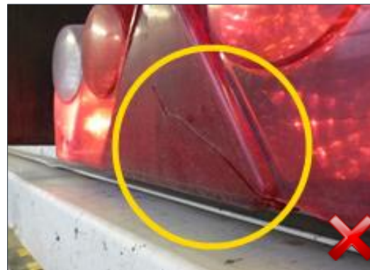
Berechnungsart: Erneuerung Teilersatz (Rücklichtglas) (100%)
